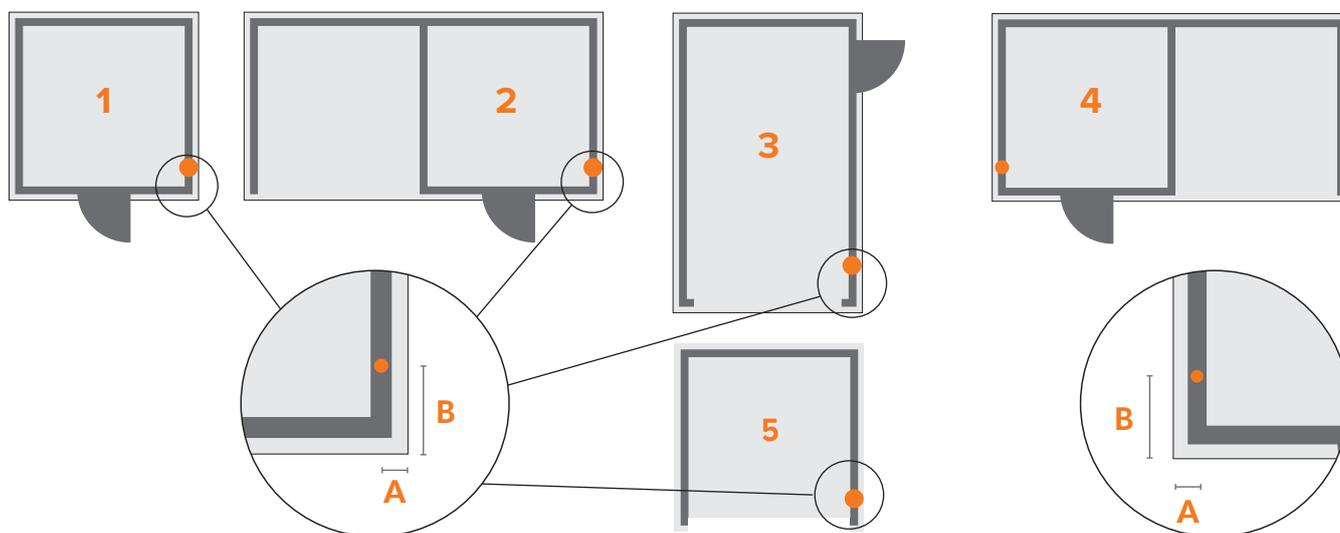
Se um tubo condutor for instalado no local indicado, ele deverá corresponder a um furo na parte inferior da parede do abrigo de jardim. Este furo tem um diâmetro de 36 mm. As dimensões são baseadas na base de cimento descrita acima.
